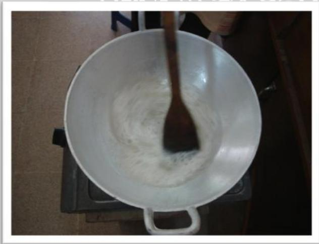
**Gambar I.4 Buih Mulai Terbentuk pada Proses Pemanasan Nira tanpa Zat Anti Buih**
