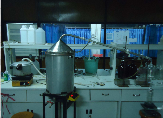
Gambar A.3.1 Rangkaian alat untuk distilasi uap distilasi uap
