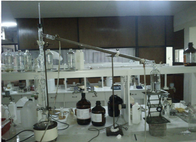
Gambar A.5 Rangkaian alat untuk redistilasi
