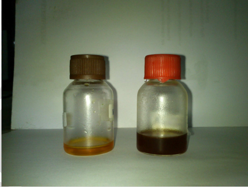
Gambar A.7.1 Gambar minyak atsiri hasil pemisahan dengan gravitasi (kiri) dan hasil ekstraksi lapisan air (kanan)
