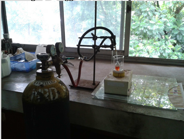
Gambar A.6 Sampel saat dilakukan paparan dengan gas N_2
