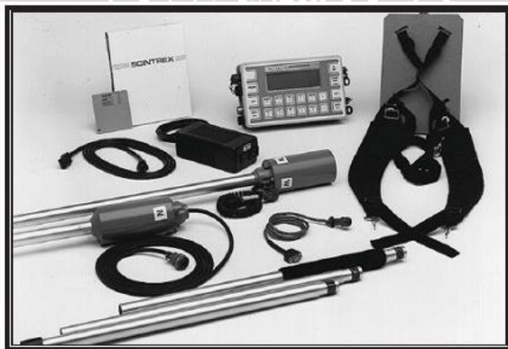
Gambar L.2. Set lengkap alat magnetometer
