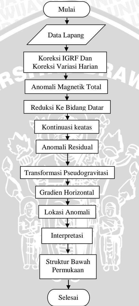
Gambar 3.5. Diagram alir pengolahan data magnetik dan interpretasi data magnetik.
