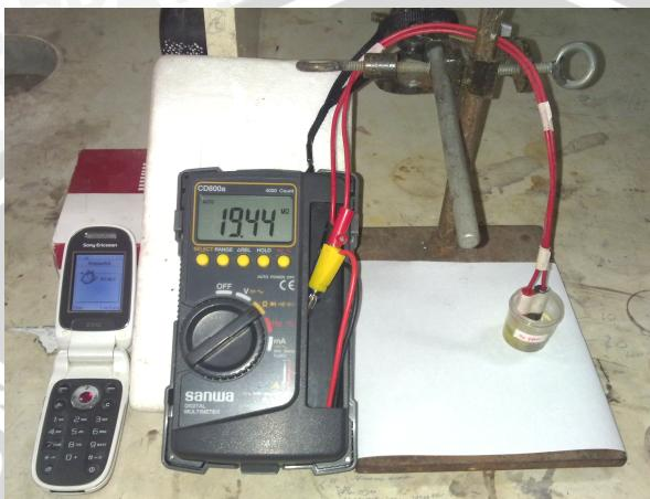
Gambar L.7.3. Rancangan biosensor konduktometri asam urat
