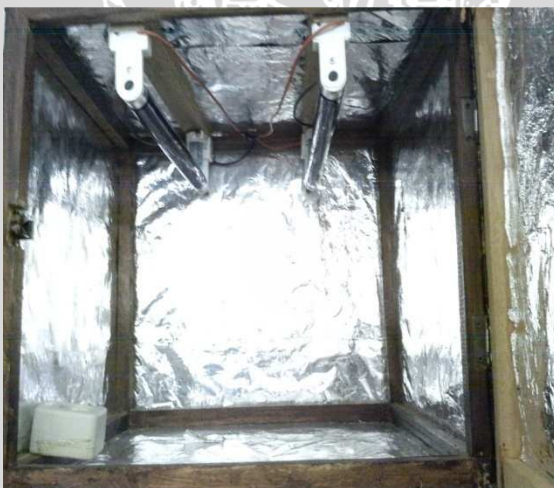
Gambar L.8 Reaktor untuk Uji Fotokatalitik (Bagian Dalam)
