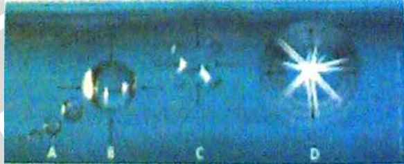
Gambar 2.9 Peristiwa kavitasi, A. pembentukan gelembung; B. perbesaran gelembung; C. penurunan tekanan; D. gelembung pecah
