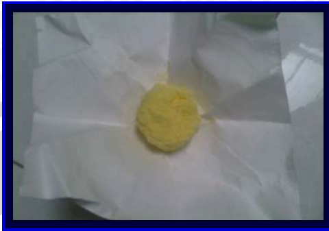
Gambar L.12.4 Nitroselulosa hasil sintesis tanpa menggunakan gelombang ultrasonik dengan perbandingan berat \text{H}_2\text{SO}_4 : \text{HNO}_3 = 2 : 1
