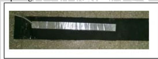
**Gambar 3.3** sensor piezoelektrik
