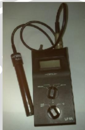
**Gambar 2.4** Konduktometer (merk WTW tipe LF91)
