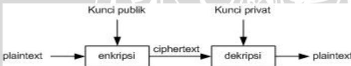
Gambar 2.4 Enkripsi dan deskripsi pada algoritma kunci asimetris
