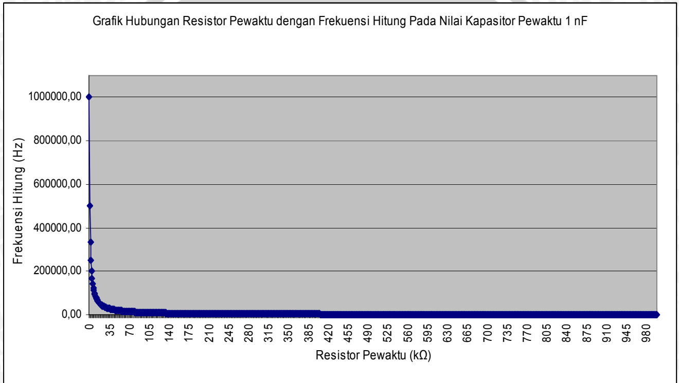
Gambar 4.2 Grafik hubungan resistor pewaktu dengan frekuensi hitung pada nilai kapasitor pewaktu 1nF
