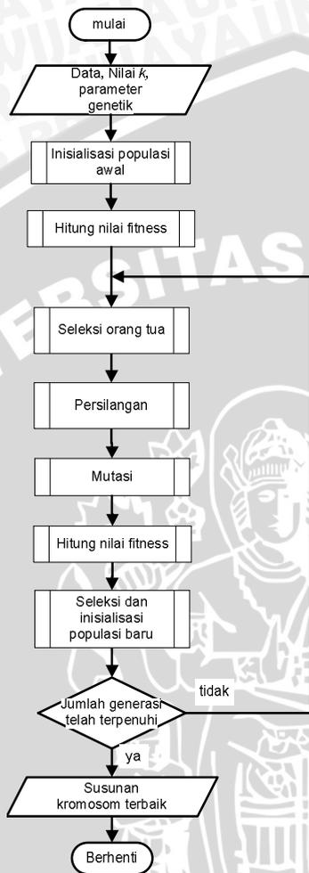
**Gambar 3.1** Diagram alir proses algoritma genetika
