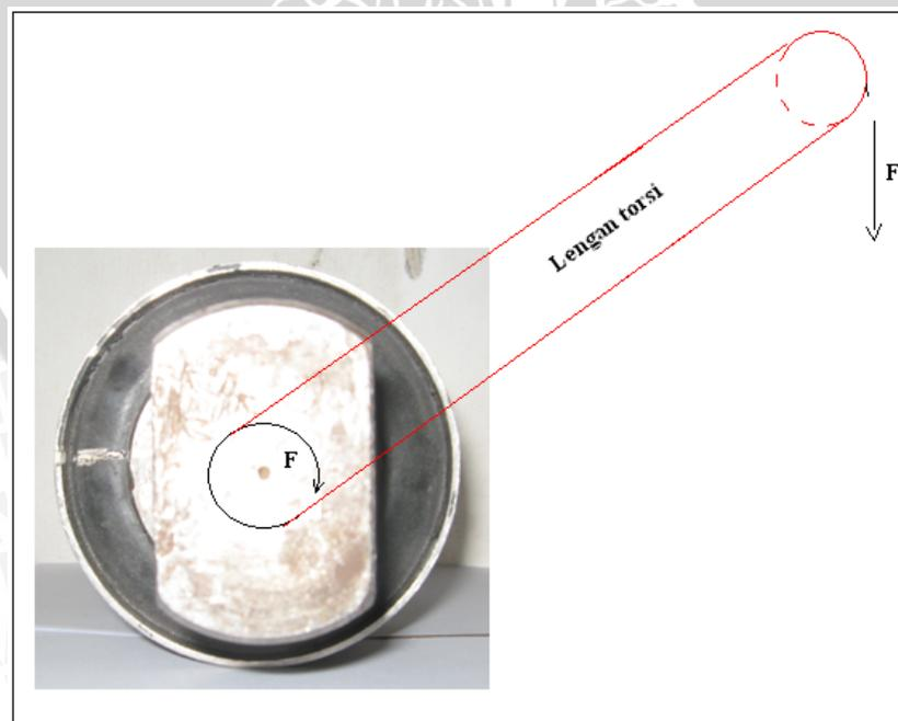
Gambar 3.11 Uji deformasi torsional.
