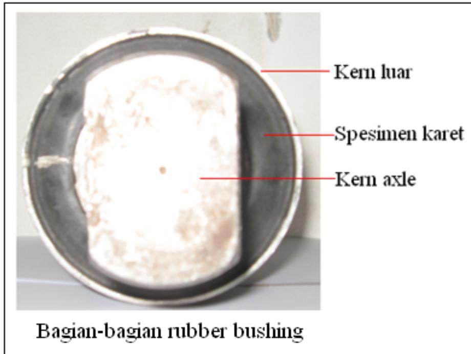
Gambar sampel *rubber bushing* terlihat dari atas atau bawah.
