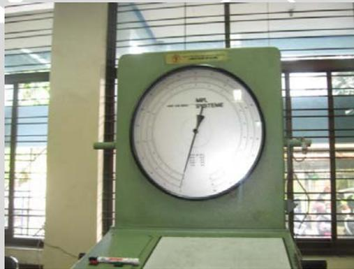
Gambar 3.12b Skala gaya pengujian deformasi radial
