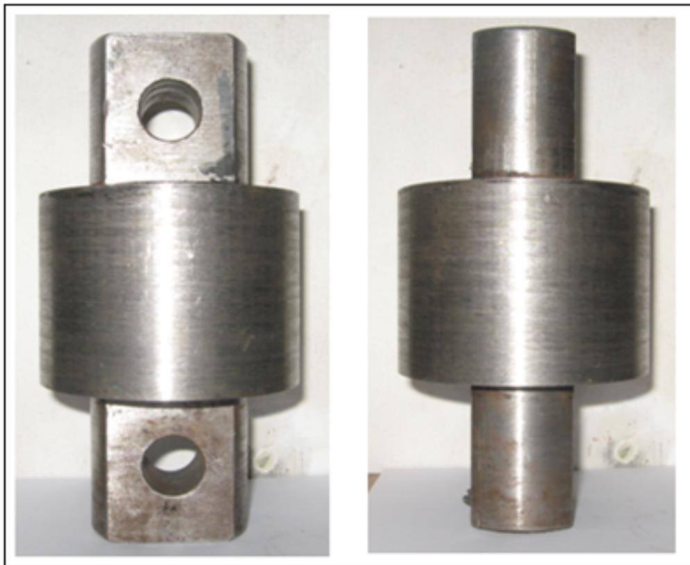
Gambar sampel *rubber bushing* terlihat dari depan dan samping.
