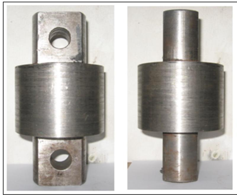
Gambar 2.1a *Rubber bushing* terlihat dari depan dan samping.
