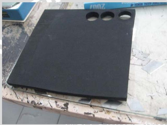
Gambar 3.6 Sampel spesimen karet untuk pengujian kekerasan
