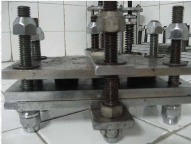
Gambar 3.9. Alat uji pampatan tetap
