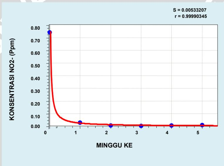
**Gambar. 4.7.** Grafik kurva pengukuran kadar  $\text{NO}_2^-$  dengan eceng gondok.
