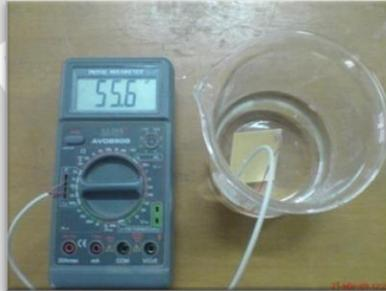
**Gambar 3.8.** Pengujian nilai kapasitansi sensor IDT
