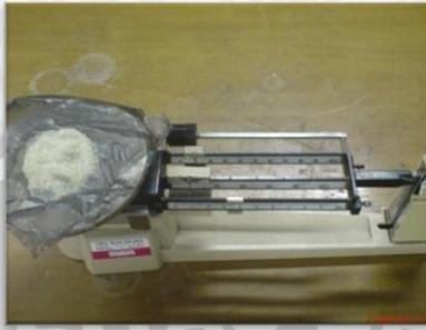
**Gambar 3.6.** Penimbangan gula pasir dengan neraca O hauss
