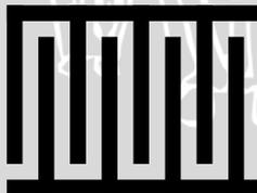
**Gambar 3.4.** Rancangan sensor IDT dengan lebar dan jarak 3 mm
