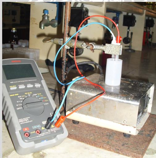
Gambar L.2.6 Rangkaian alat pengukuran potensial sel
