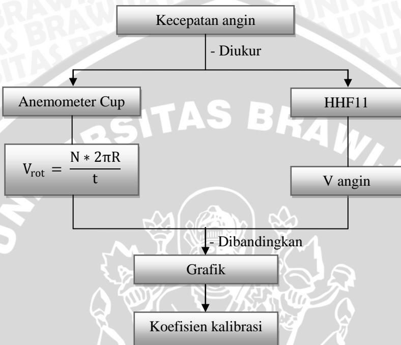
**Gambar 3.10 Diagram alir kalibrasi sensor kecepatan angin**
