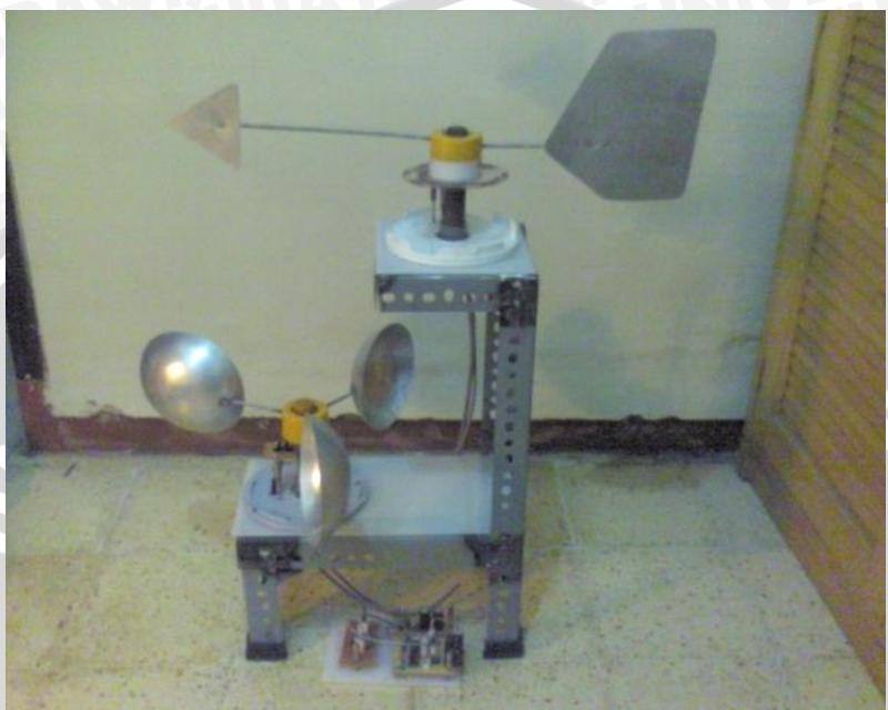
Gambar L.1 Stasiun Pencatat Parameter Cuaca
