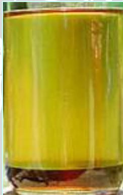
**Gambar 4.2 Endapan gliserin pada biodiesel**
