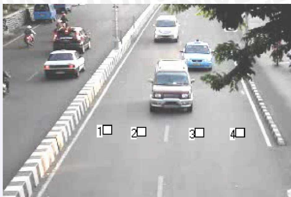
Gambar 3.6 Contoh Posisi dan Resolusi Titik Sensor
