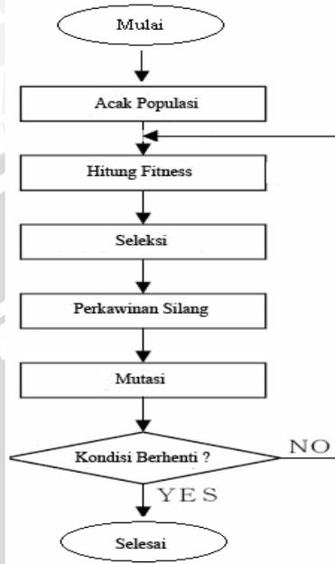
Gambar 2.1 Struktur Umum algoritma genetik
