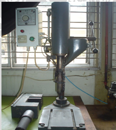
Gambar 3.2 Mesin cetak injeksi
