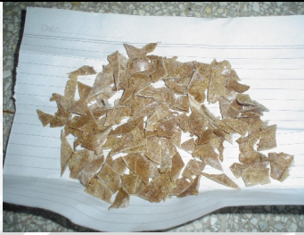
Gambar 3.13 Campuran polietilen dan serbuk kayu sebelum dimasukkan mesin injeksi
