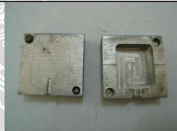
Gambar 3.4 cetakan untuk metode injection molding
