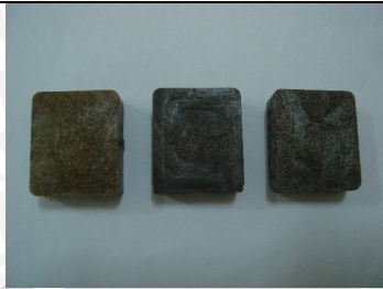
Gambar 3.7 sampel dengan matrik polipropilen
