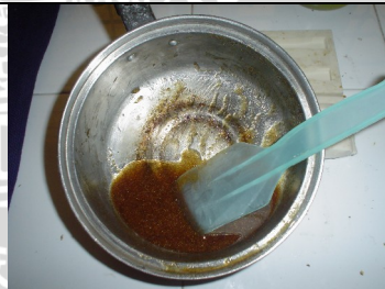
Gambar 3.12 campuran poliester dengan serbuk kayu
