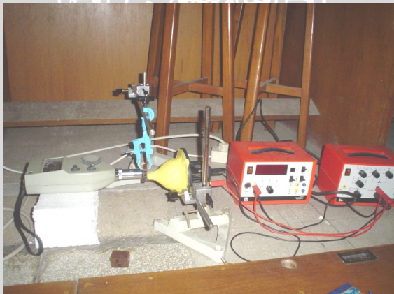
Gambar 3.4 Rangkaian alat uji serapan bunyi
