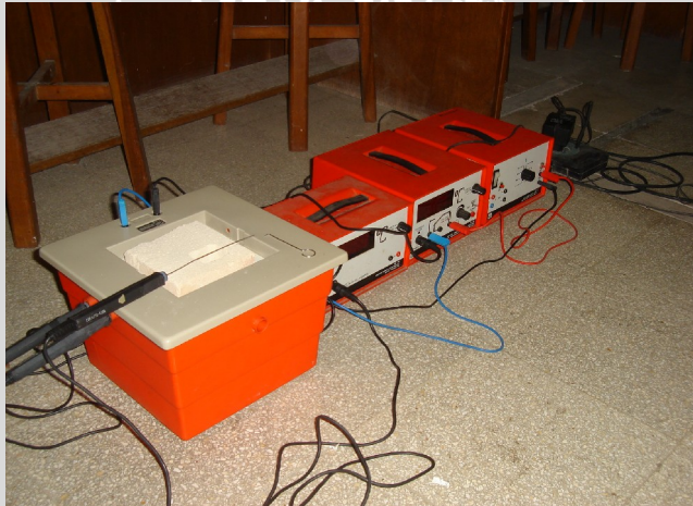
Gambar 3.3 Rangkaian alat uji konduktivitas termal
