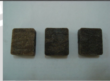
Gambar 3.8 sampel dengan matrik polietilen
