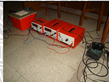
Gambar 3.18 rangkaian alat uji konduktivitas termal
