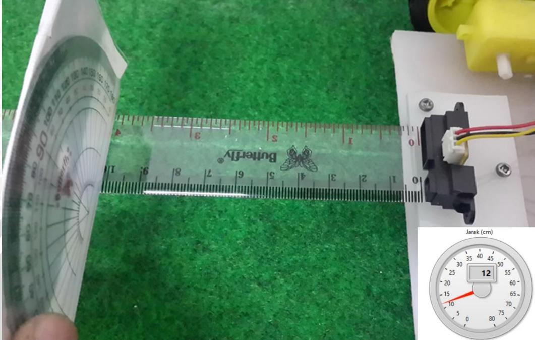
**Gambar 6.2** Pengujian Sensor Jarak
