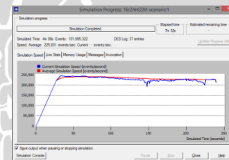
Gambar 4. 18 Runtime Simulator yang diset berjalan 4 menit dan menampilkan grafik pengerjaan dari proses simulasi tersebut dengan satuan (event/second) dari topologi 16 GSM yang diuji
