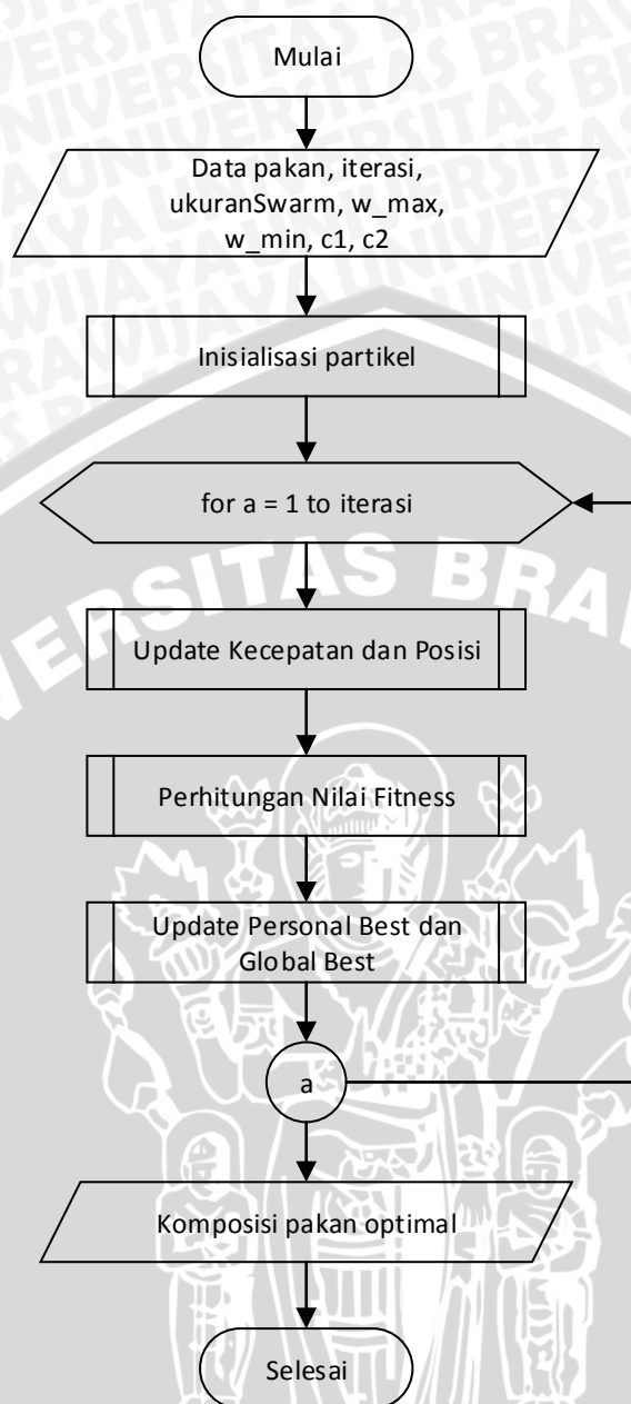
Gambar 4.1 Diagram Alir Proses Optimasi Komposisi Pakan Sapi Perah Menggunakan Algoritma PSO
