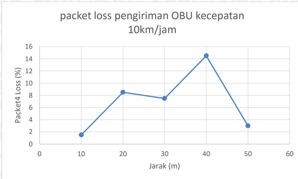
**Gambar 6. 23 Grafik *packet loss* Pengiriman OBU kecepatan 10km/jam**
