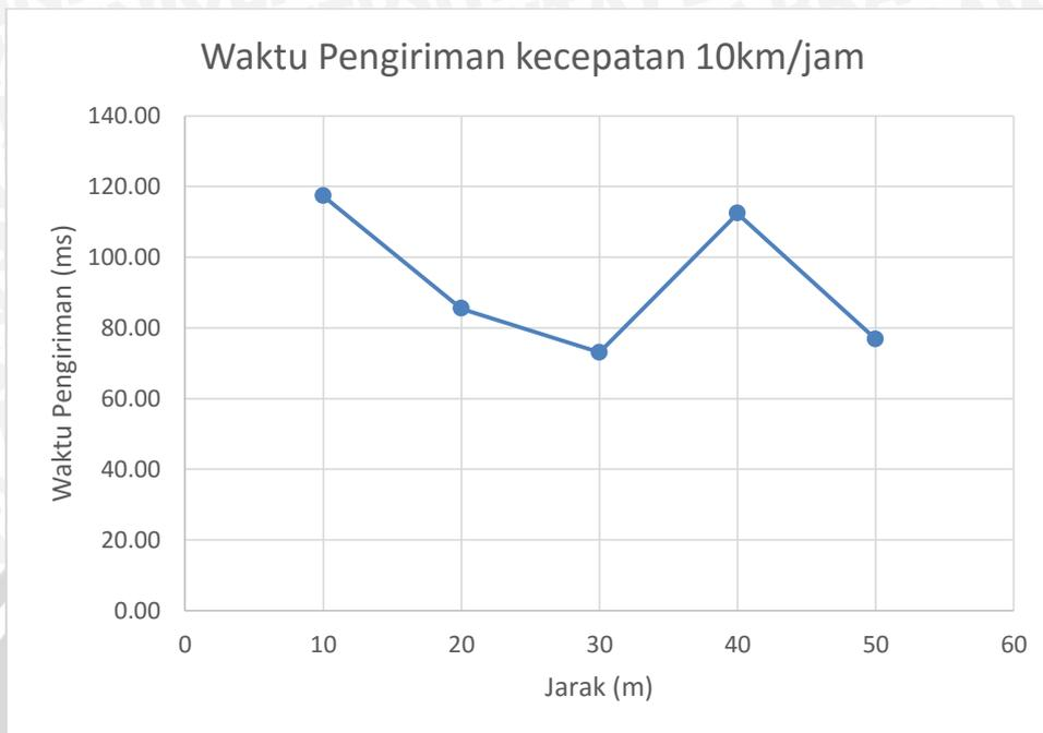
**Gambar 6. 10 Grafik Kecepatan Pengiriman RSU kecepatan 10km/jam**
