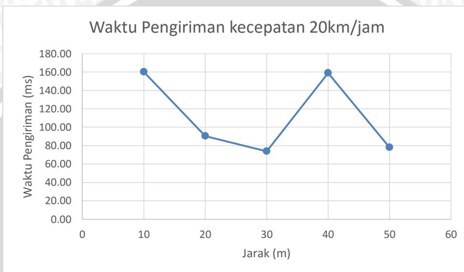
**Gambar 6. 13 Grafik Kecepatan Pengiriman RSU kecepatan 20km/jam**
