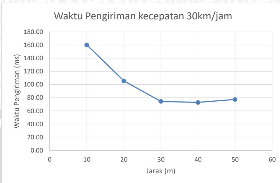
**Gambar 6. 16 Grafik Kecepatan Pengiriman RSU kecepatan 30km/jam**
