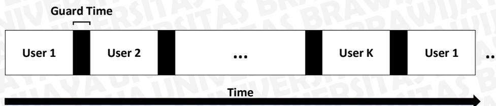
Gambar 2.4 Ilustrasi Slot Waktu TDMA
