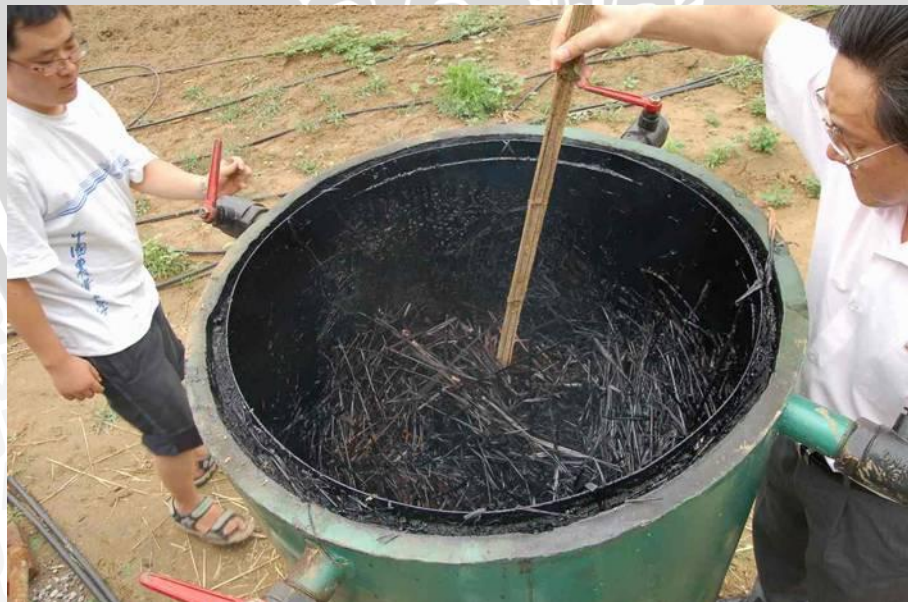
Gambar 2.6 Proses Pembuatan Biochar dengan Pirolisis
