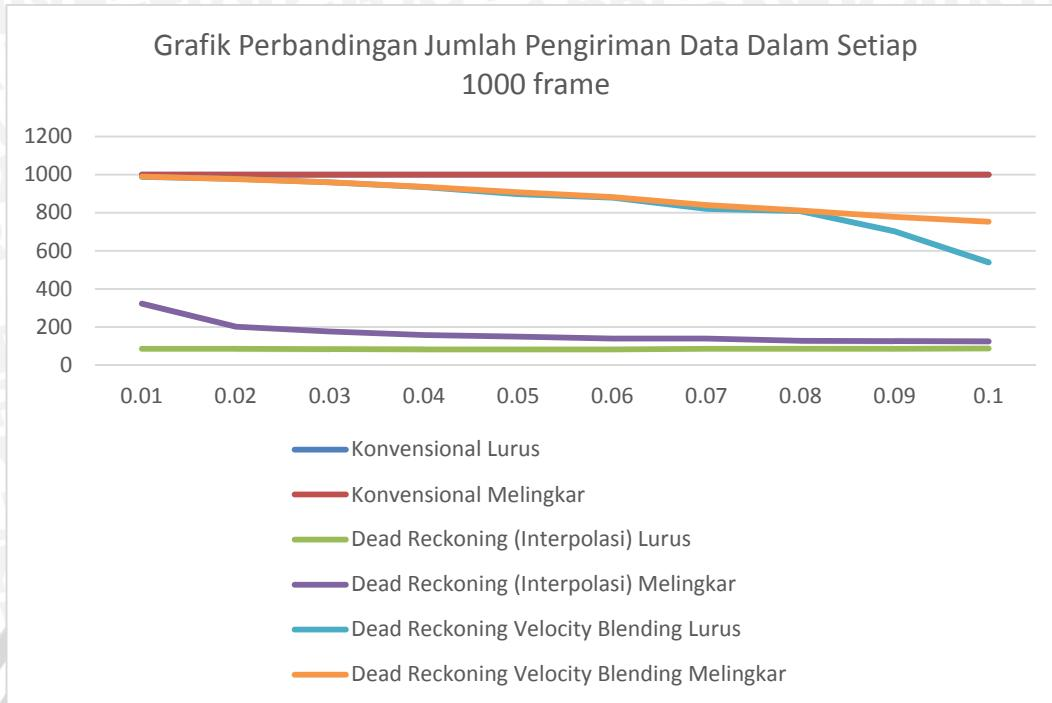
**Gambar 6.1 Grafik Perbandingan Jumlah Pengiriman Data Berdasarkan Threshold Dalam Setiap 1000 Frame**
