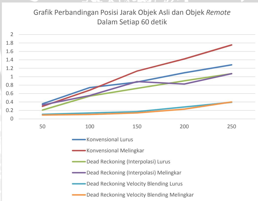
**Gambar 6.4 Grafik Perbandingan Jarak Rata-rata Berdasarkan *Latency* Dalam 60 detik**
