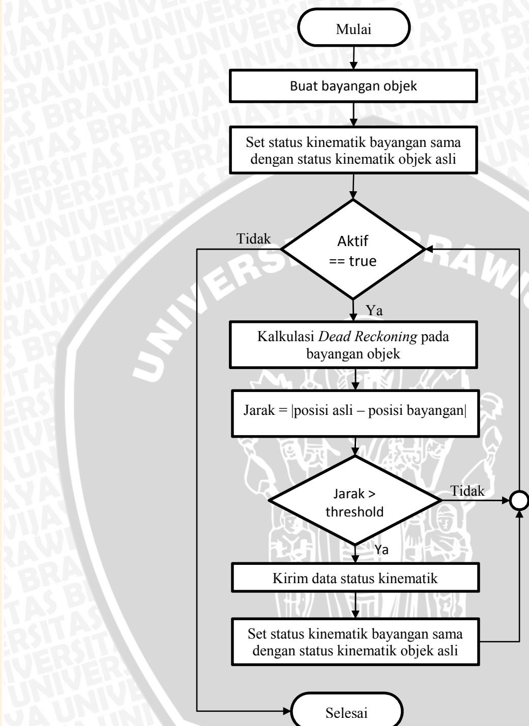
Gambar 4.2 Diagram Alir Implementasi *Dead Reckoning* pada *Local Client*
