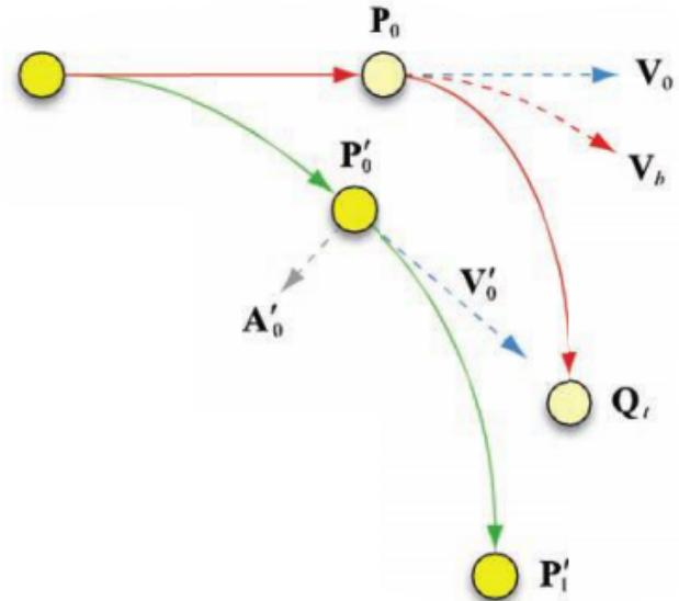
**Gambar 2.4 Dead Reckoning dengan Velocity Blending Direpresentasikan dengan Lintasan Warna Merah**
