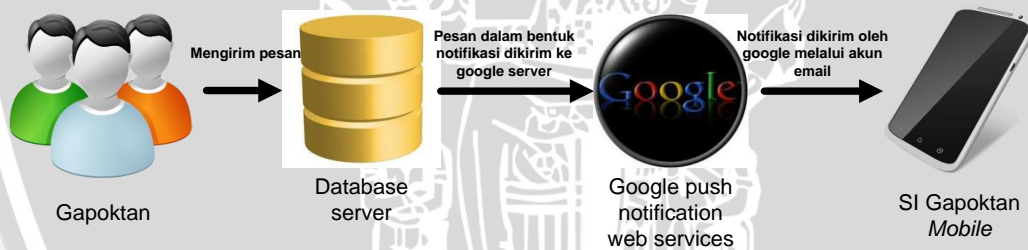
Gambar 4.5. Diagram blok pengiriman informasi GCDM. Sumber : [Perancangan]
