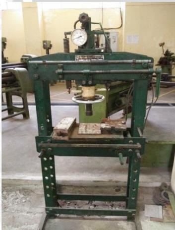
Gambar 3.8 Mesin *press hidrolik*
