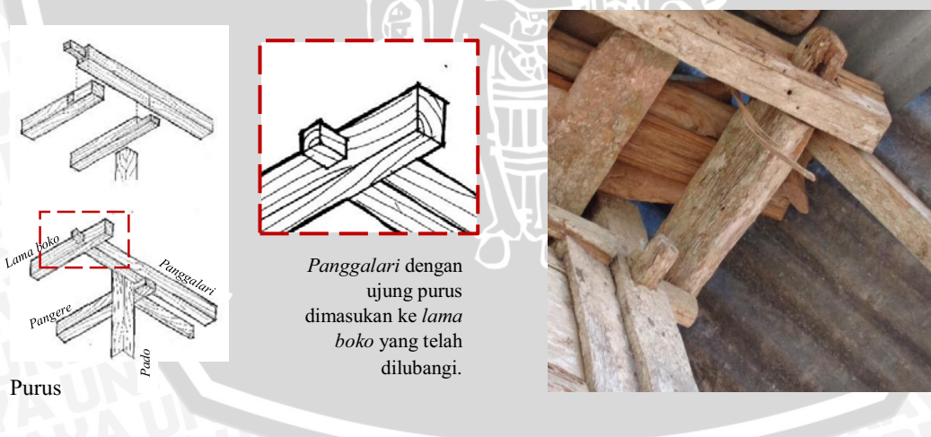
Gambar 4.74 Ragam sambungan titik 1 pada bagian taja
