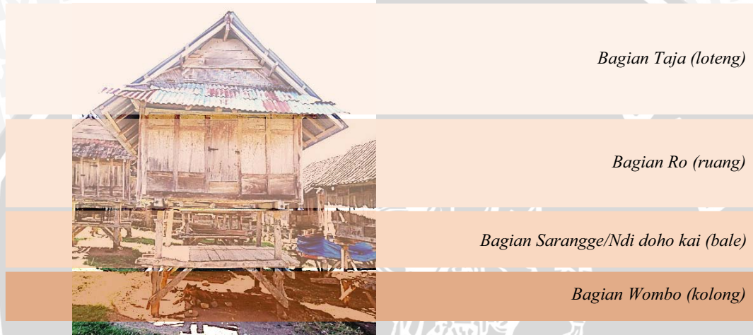
Gambar 4.3 Pembagian ruang vertikal pada Uma Jompa
