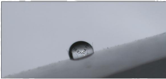
Gambar 9. Pemotretan Sudut Kontak Pada Permukaan Isolator Pos Silicone Rubber
