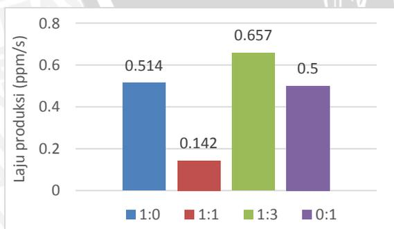
Gambar 13 Laju produksi hidrogen pada perbandingan 1:0, 1:1, 1:3, 0:1 (perbandingan CuZn : karbon aktif)
