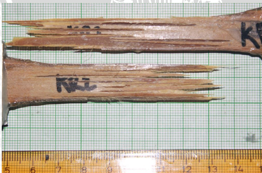
Gambar 4.17 Bentuk tampak atas patahan specimen Uji Tarik matrik Ripoxy
