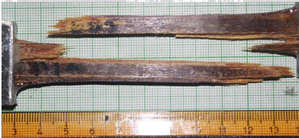
Gambar 4.21 Bentuk tampak atas patahan specimen Uji Tarik matrik Polyester
