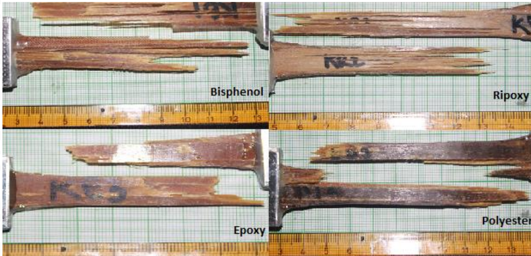
Gambar 4.7 Perbandingan patahan tiap variasi komposit
