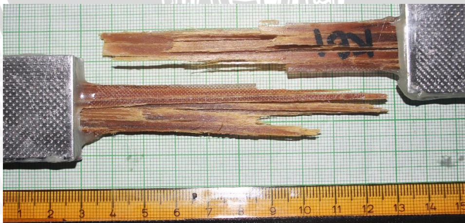
Gambar 4.9 Bentuk tampak atas patahan specimen Uji Tarik matrik Bisphenol
