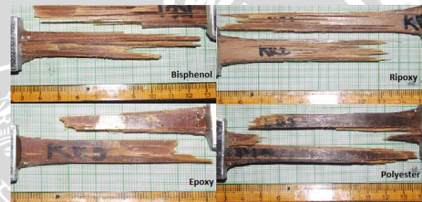
Gambar 4 Perbandingan patahan tiap variasi komposit
