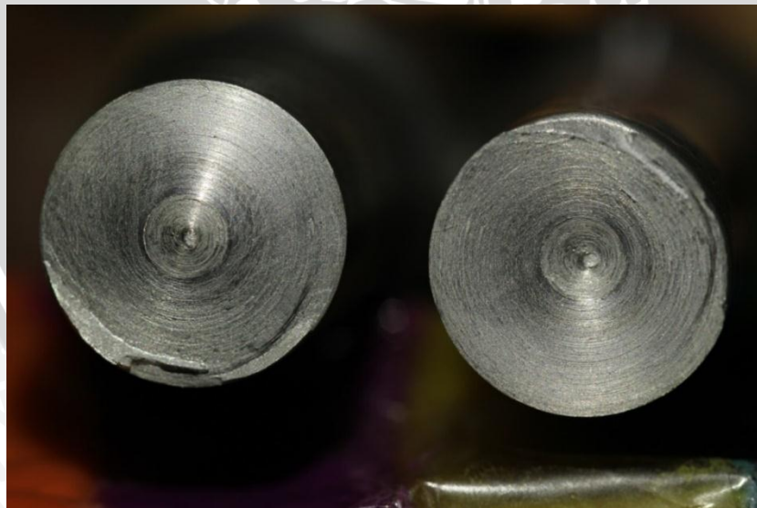
Gambar 9 Bentuk Patahan dengan Nilai Kekuatan Puntir Tertinggi
