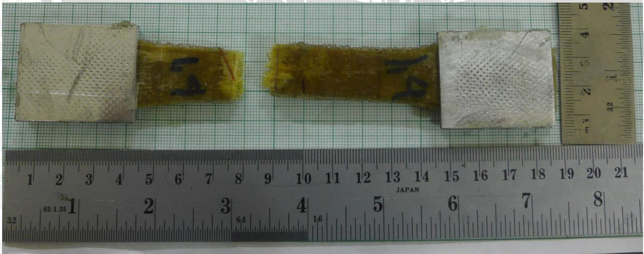
Gambar 4.8 Bentuk tampak atas patahan specimen Uji Tarik Orientasi ( 0^{\circ}, 90^{\circ} )
