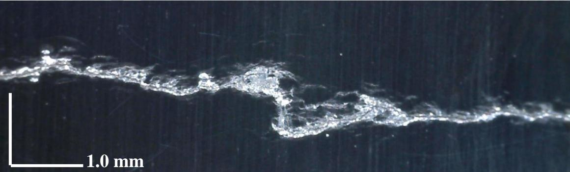
Lampiran 3 patahan pada spesimen  $R = 0.3$ ,  $S_{max} = 21$  MPa
