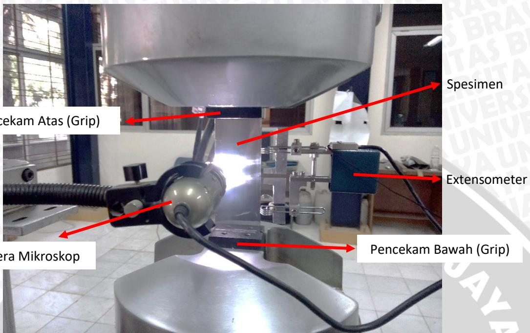
Gambar 3.10 Instalasi penelitian uji *fatigue*
