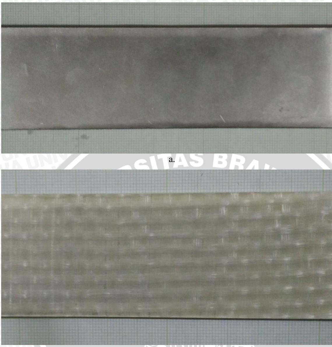
Gambar 3.13 Ciri-ciri penampang yang berhasil, a. penampang luar yang bagus, b. bagian dalam dari penampang luar yang bagus
