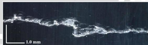
Gambar 9. Perambatan retak pada R = 0.2 (a) sebelum kedua ujung retak menyatu, (b) saat kedua ujung retak menyatu dan pembebanan terus berlanjut
