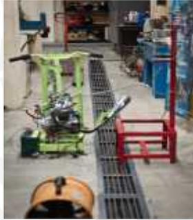
Gambar 4 Motor Bakar 6 Langkah
