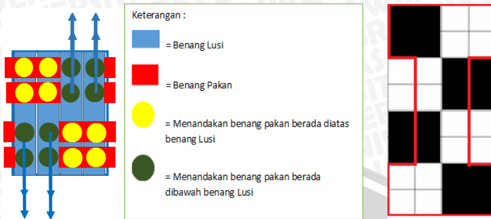
Gambar 4.6 Ilustrasi gaya pada anyaman basket dan bentuk spesimen basket
