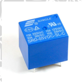
Gambar 2.8 Relay songle SPDT Sumber: Dokumentasi penulis
