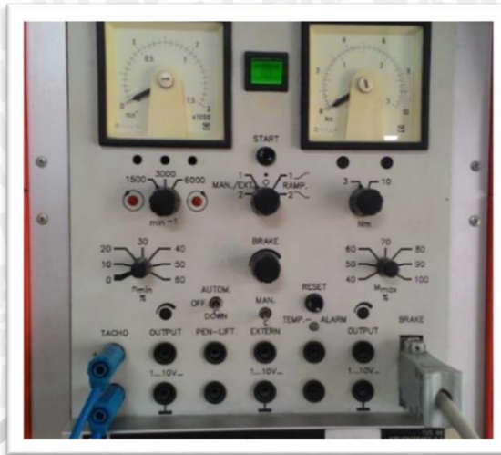
Gambar 2.3 Control Unit 0,3 kW yang ada di Laboratorium Elektronika Daya JTE FT-UB
