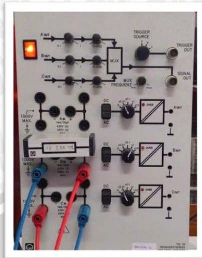
Gambar 2.4 Isolation Amplifier yang ada di Laboratorium Elektronika Daya JTE FT-UB
