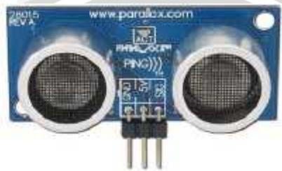
Gambar 2.4 Sensor Ultrasonik PING)))
