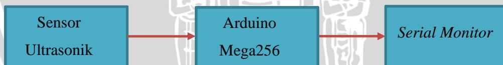
Gambar 3.5 Blok Diagram Pengujian Sensor Ultrasonik PING))
