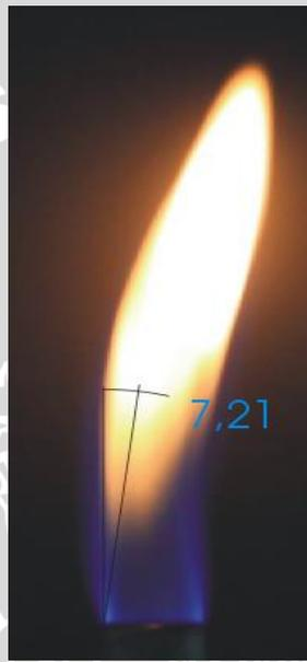
Gambar 4.3: Pengolahan data sudut api pada nyala api dengan bahan bakar minyak kelapa sawit mentah
