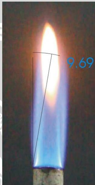
Gambar 4.4: Pengolahan data sudut api pada nyala api dengan bahan bakar minyak kelapa sawit non gliserol
