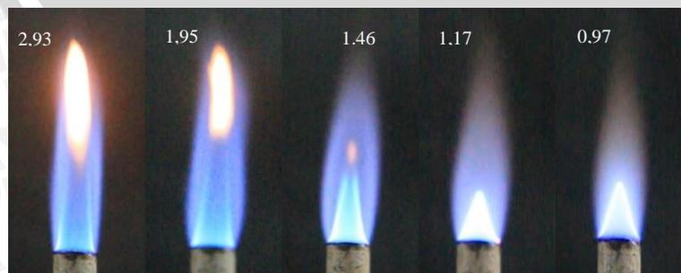
Gambar 4.2 Nyala Api dengan bahan bakar minyak kelapa sawit non gliserol
