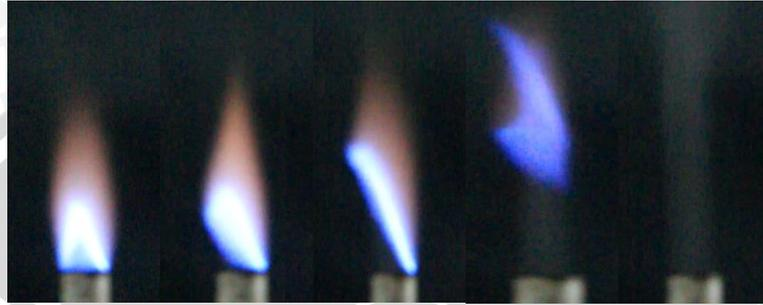
Gambar 4.7 Nyala Api dengan bahan bakar minyak kelapa sawit non gliserol  $\phi$  0,83
