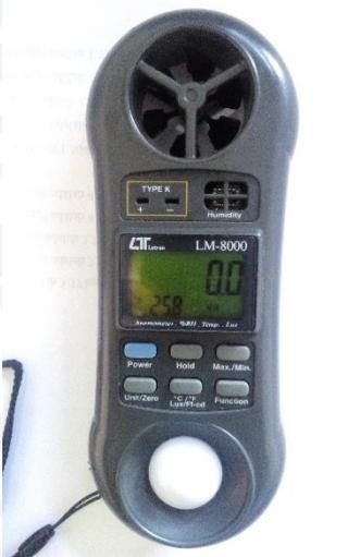
Gambar 3.4 Anemometer Digital
