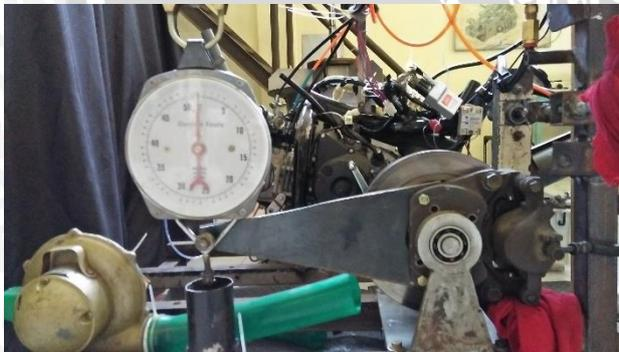
Gambar 3.3 Dinamometer
