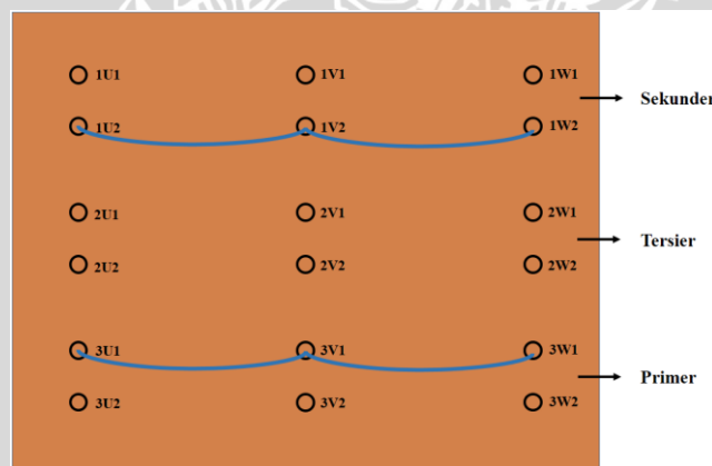
Gambar 4.1 Rangkaian Transformator Hubungan Y-Y
