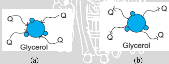
Gambar 4.13 (a) Konsep Gliserol Sebagai akumulator panas pada pembakaran bahan bakar nabati bersifat menyerap panas. (b) Konsep Gliserol Sebagai akumulator panas pada pembakaran bahan bakar nabati bersifat menyuplai panas
