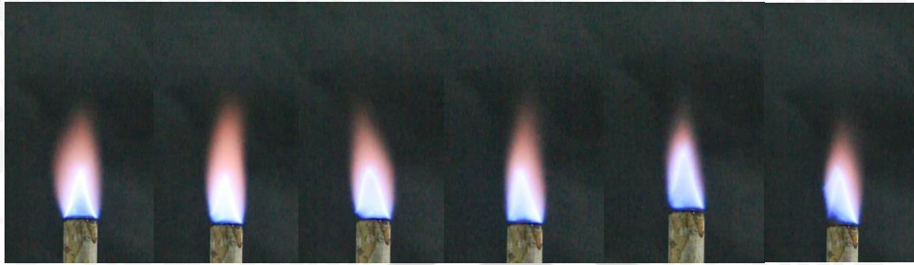
Gambar 4.5 Mekanisme Nyala Api Tidak Stabil Minyak kelapa mentah pada Equivalence Ratio ( \phi ) = 0,64
