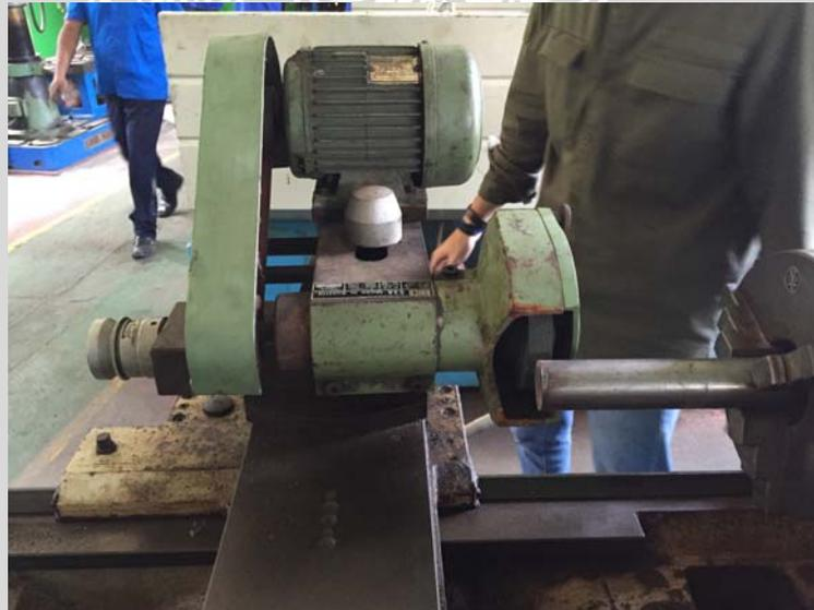
Gambar 3.9 Mesin Gerinda *Toolpost* pada *Toolpost* Mesin Bubut
