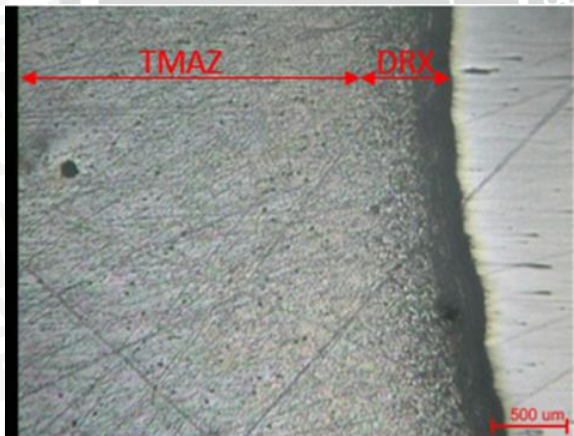
Gambar 4.10 Hasil foto mikro pada spesimen dengan kekerasan tertinggi
